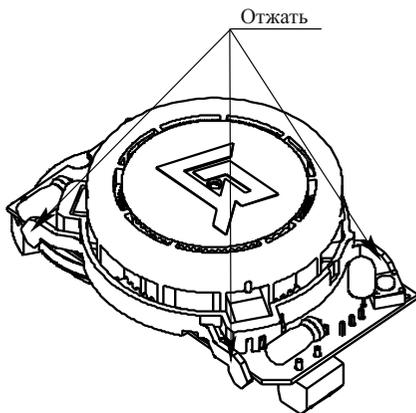
Рисунок 1 – Место расположения замков на дымовой камере
